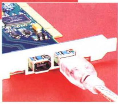
Particolare dei due connettori IEEE1394 presenti sulla scheda PCI, con in evidenza un capo del cavetto 6poli-6poli a corredo con il disco esterno.
